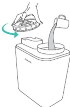
4. Riempire il serbatoio dell'acqua con acqua, riavvitare il tappo del serbatoio dell'acqua e riposizionare accuratamente il serbatoio dell'acqua sulla base. Il livello del serbatoio dell'acqua può essere visualizzato attraverso la finestra sul lato sinistro.
