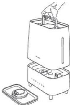
3. Capovolgere il serbatoio dell'acqua e svitare il tappo del serbatoio dell'acqua rimuovendolo dal serbatoio. Il filtro al carbonato di calcio sarà attaccato al tappo del serbatoio dell'acqua.
